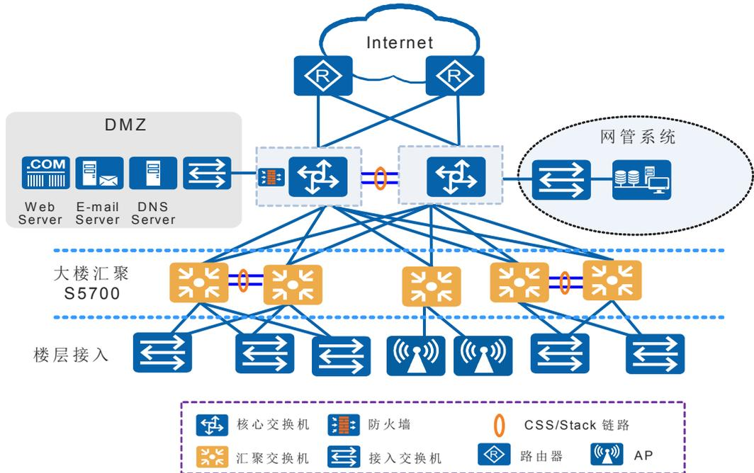
在企业网络和园区网中，S5730SI通过千兆/百兆接口接入交换机，提供高性能大容量交换，上行通过万兆光口接入核心交换机，构成万兆骨干、百兆到桌面的企业网全网解决方案，满足用户高带宽、多业务的需求。
