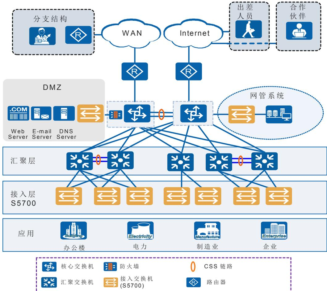
S5730SI提供丰富的终端安全管理特性，支持PoE、Voice VLAN、Qos等功能，可以轻松的提供多样化的桌面接入功能，实现千兆到桌面的高性能网络。
