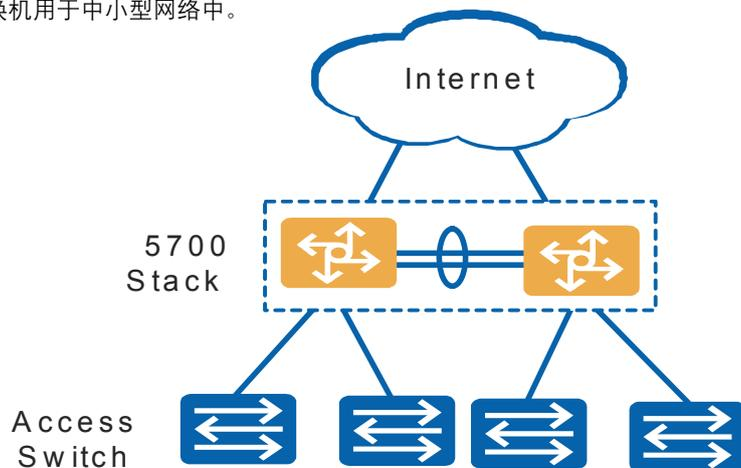
S5730SI使用智能堆叠技术，可以多台设备互相备份，保障核心设备的高可靠性。支持丰富的用户接入控制策略，用户集中管理，简化配置。
